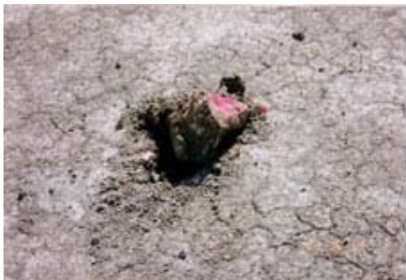
Abb. 5: Unzulässige Korngrößen in der mineralischen Dichtungsoberfläche
